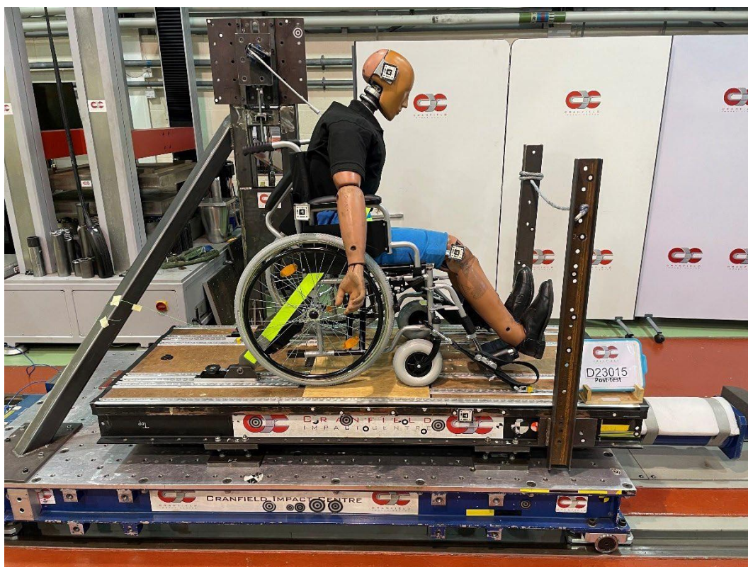
(Kolečkové křeslo 0811300 během nárazového testu)
